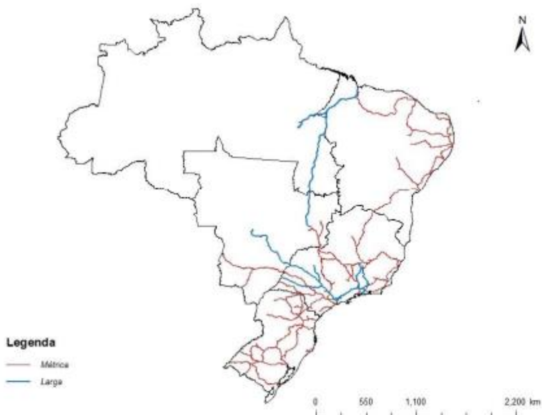
Figura 2 - Rede ferroviária brasileira por bitolas Fonte: ANTT (2017) inspirado em Théry & Mello (2005), com adaptações.
