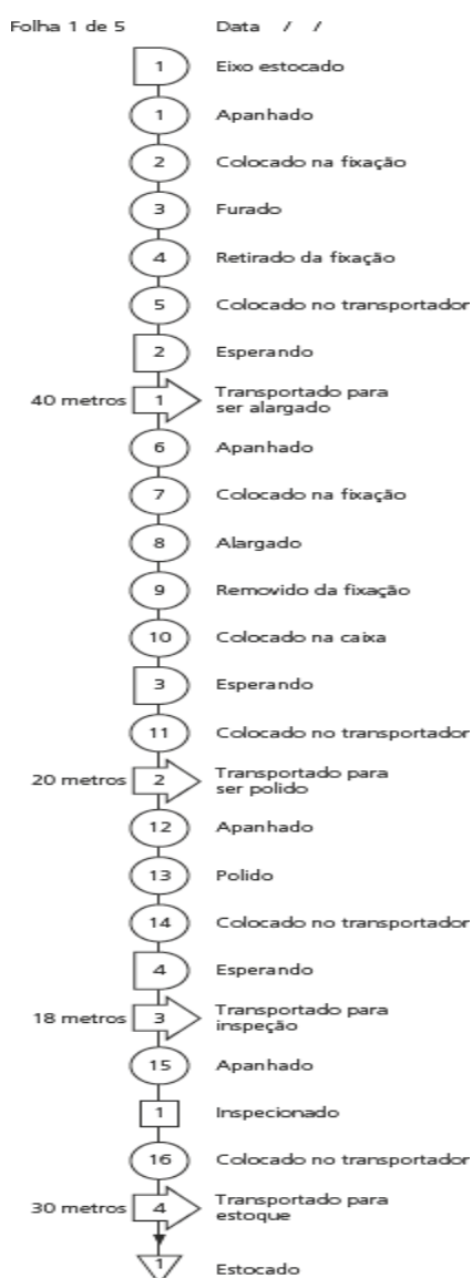
Figura 12: Representação gráfica dos transportes, atrasos e estocagens no diagrama de fluxo.
