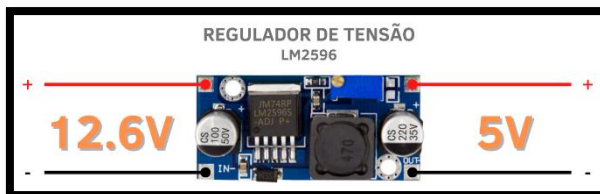
Figura 5 – Demonstrativo do regulador de tensão LM2596
