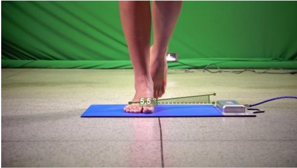
Figura 7: utilização do software Kinovea para avaliação do ângulo de antepé. Fonte: Dados da pesquisa. (2018)
